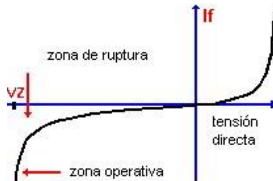
Figura 51. Curva Característica Diodo Zener
